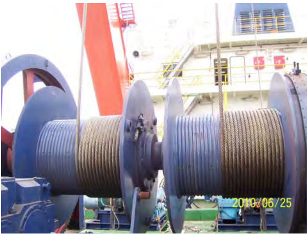
图 5 起升钢丝绳卷绕在 Lebus 绳槽卷筒上
