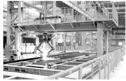
图 1 国外船厂已建成的小组立智能流水线
