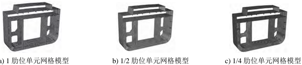
图 1 3 种不同网格尺寸计算模型
