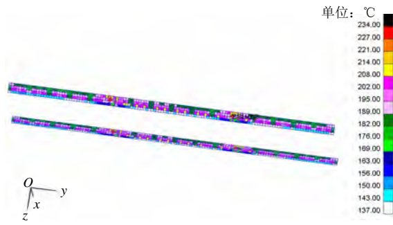
图 12 顶边舱斜板相当应力分布
