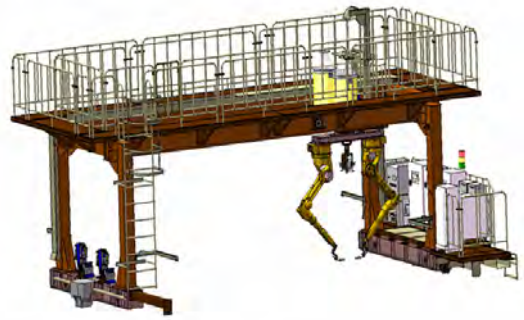
图 3 焊接机器人工作站总体布置形式
